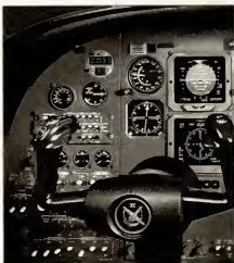
Deo kokpita jednog Cessna aviona sa dva EFIS (Electronic Flight Instruments System) displeja
